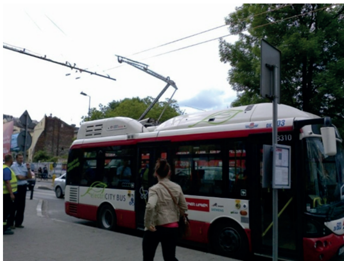
Rys. 4. Ładowanie autobusu elektrycznego pierwszym w Polsce pantografem
